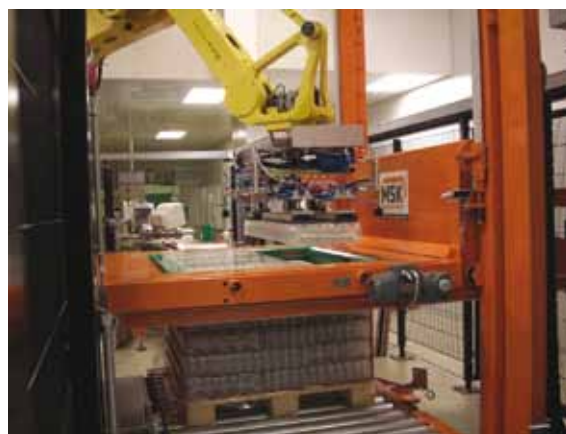
SGD KIPFENBERG的机器人码垛机正在抓取空瓶组
