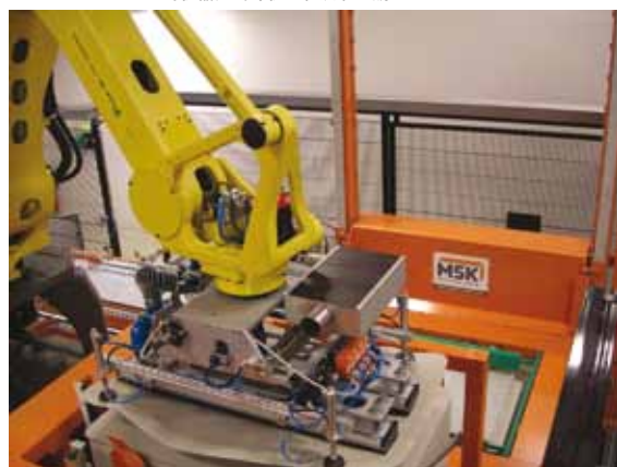
机器人码垛机正在放置纸质隔板的操作
